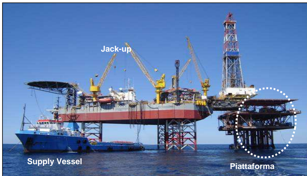
Figura 2.1 – Impianto di perforazione ("Jack-up") posizionato presso una piattaforma.
