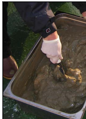
Figura 2.3 - Campionamento dei sedimenti. A sinistra: benna limnologica Van Veen; a destra: omogeneizzazione del campione.
