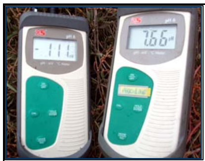
Figura 2.4 - Strumentazione utilizzata per la misura di Temperatura, pH e Potenziale Redox nel sedimento campionato. A sinistra: sonda PH 6 XS; a destra: prime misure in campo del sedimento campionato.
