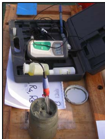
Figura 2.4 - Strumentazione utilizzata per la misura di Temperatura, pH e Potenziale Redox nel sedimento campionato. A sinistra: sonda PH 6 XS; a destra: prime misure in campo del sedimento campionato.
