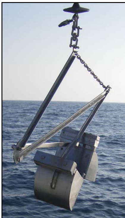
Figura 2.3 - Campionamento dei sedimenti. A sinistra: benna limnologica Van Veen; a destra: omogeneizzazione del campione.
