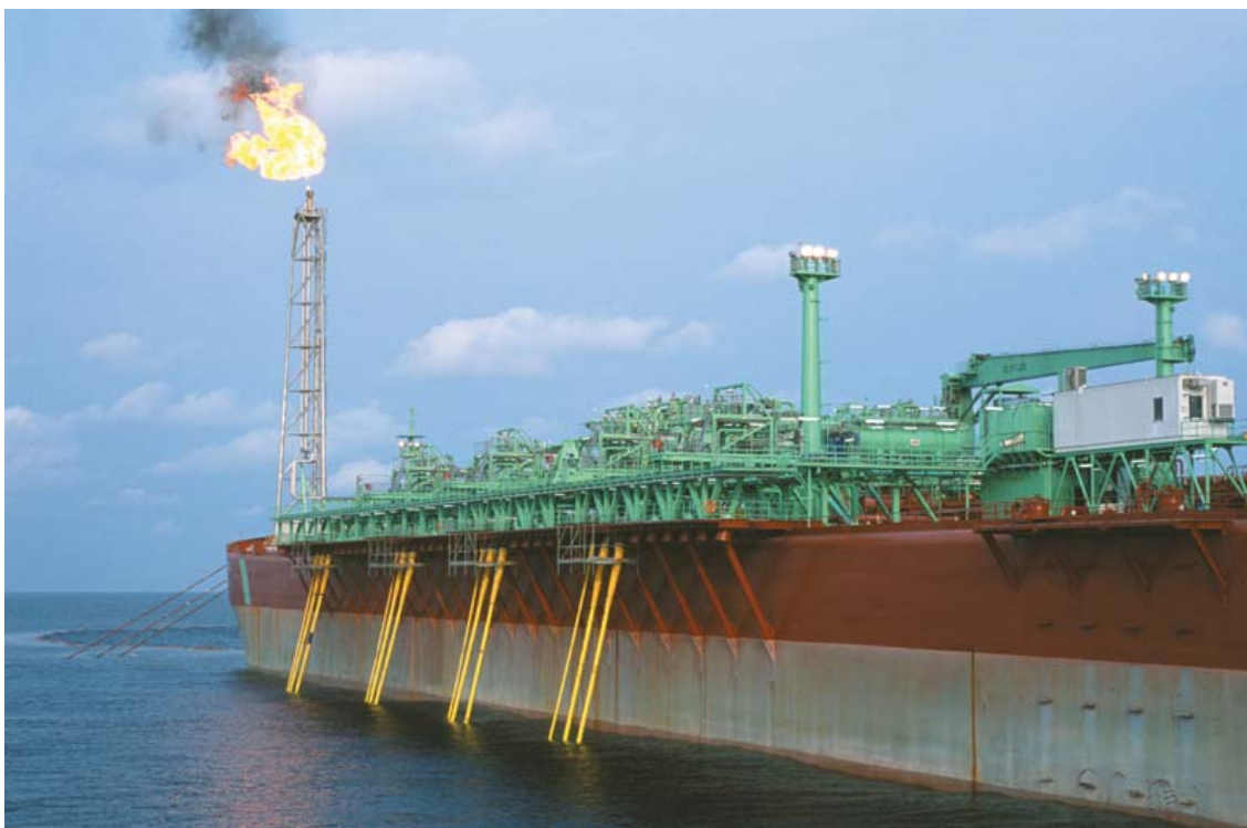
Fig. 1 FPSO al lavoro. Una miniraffineria off-shore. I documenti della Medoil Gas S.P.A contemplano l'utilizzo di una simile struttura.
