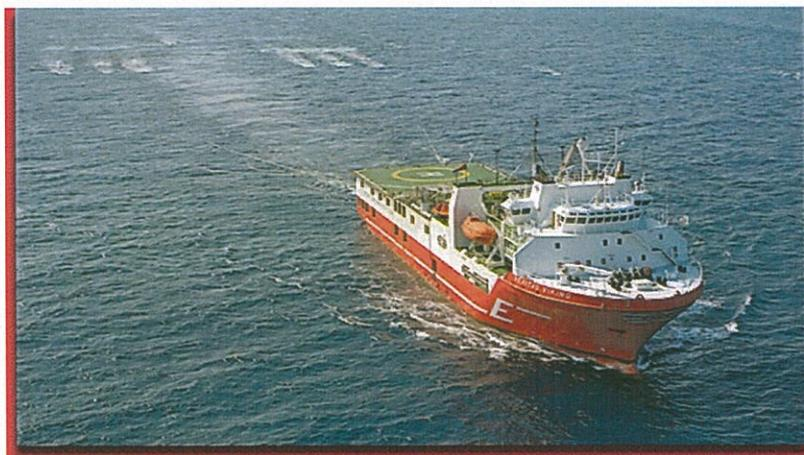
Figura 11. Nave per acquisizione sismica.
