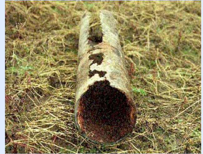
Tubo corroso da petrolio saturo di zolfo
