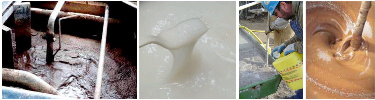
FIG. 13: Esempi di fanghi e fluidi perforanti usati per le operazioni di scavo e di formazione dei pozzi petroliferi
