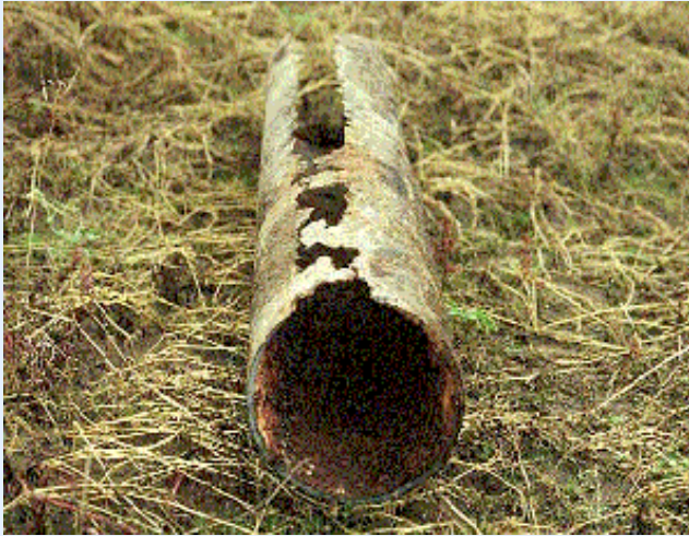
Tubo corroso da petrolio saturo di zolfo
