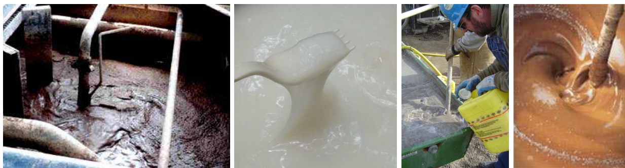
FIG. 41: Esempi di fanghi e fluidi perforanti usati per le operazioni di scavo e di formazione dei pozzi petroliferi
