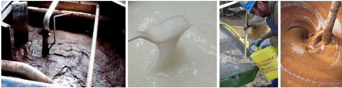
FIG. 2: Esempi di fanghi e fluidi perforanti usati per le operazioni di scavo e di formazione dei pozzi petroliferi
